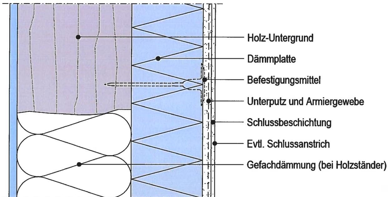
Wärmedämm-Verbundsystem "Knauf WARM-WAND Natur T
