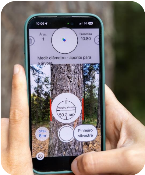
Fig. 1. Medição digital de árvores com a App Arboreal Floresta
