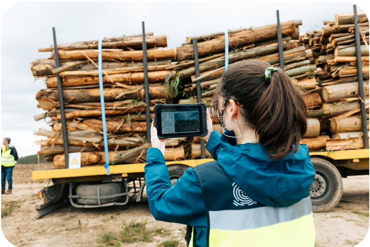
Fig. 3. Testes conduzidos pelo CoLAB ForestWISE no âmbito do projeto transForm – Floresta 4.0 para análise expedita de pilhas de madeira com aplicações móveis.
