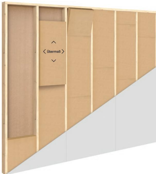
Zuschneid und Verlegung zwischen Ständern oder Sparren mit Übermaß in Länge und Breite, gefolgt von anschließendem Einklemmen.
